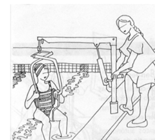
Hay grúas que permiten el acceso o la salida de la piscina para quienes no pueden hacerlo de forma autónoma.
