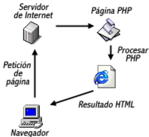
**Figura 3.2:** Secuencia de petición y ejecución de una aplicación PHP, tomada del sitio [http:// www.php.org](http://www.php.org)
